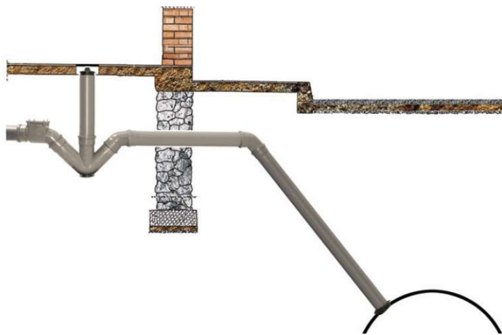
شکل ۳. اتصال لوله فاضلاب ساختمان به شبکه فاضلاب شهری
