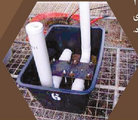
شکل ۲ دوموتناژ افقی با ۷/۵ درصد انحراف به کار گرفته شد و برای دفن آماده گردید.
